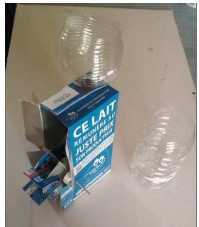
Si la turbine ne tourne pas, il faut parfois ajuster les bouchons de l'axe ou orienter le goulot de l'entonnoir pour que l'eau arrive au dessus des pales.
